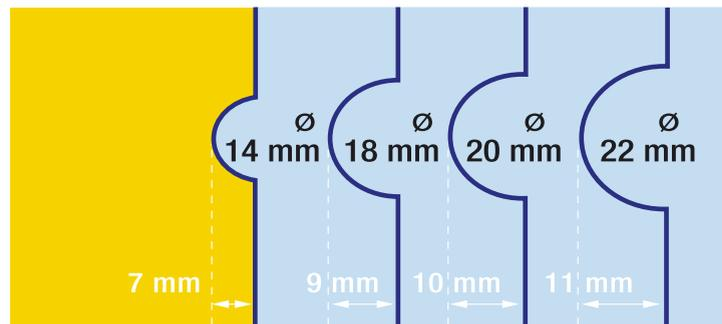
Schéma des diamètres et profondeurs **utilisées** dans notre atelier, et **préconisées** sur votre fichier de mise en page.
